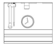
出廠時在機器下部的壓力表顯示了設定的泵浦壓力。
